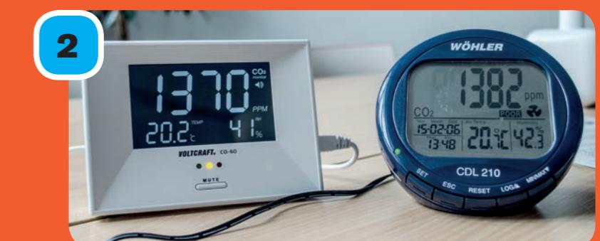
Um herauszufinden, wie oft in den Klassen gelüftet wird und wie gut die Luft über mehrere Tage hinweg ist, stellen wir Datenlogger auf, die CO<sub>2</sub>-Werte und Temperaturen aufzeichnen.
