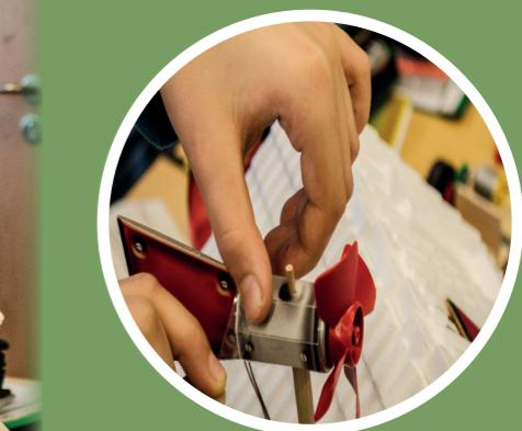
*Da oben hinter dem Windrad steckt ein kleiner Generator drin, der die Bewegung des Windrads in Strom umwandelt. Im Generator dreht sich eine Kupferdrahtspule in einem magnetischen Feld, das bringt die Elektronen im Draht auf Trab.*
