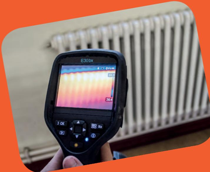
Die Thermostate an den Heizkörpern unserer Schule (Bild oben) kann man nicht von Hand drehen. Sie werden von einem zentralen Computer gesteuert. Mit Infrarot-Thermometern (Bild oben links) können wir messen, wie warm ein Heizkörper ist. Mit der Wärmebildkamera (Bild links) kann man sogar die unterschiedliche Wärmeverteilung in einem Heizkörper sichtbar machen.
