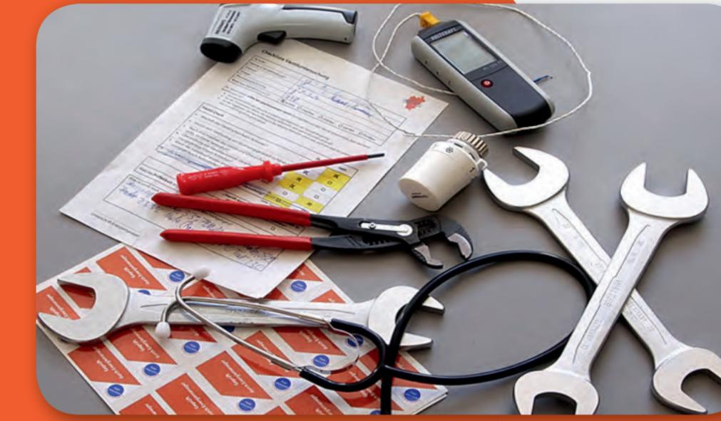
Das sind einige unserer **Messgeräte**: Infrarot-Thermometer, digitale Luftthermometer, aber auch Schraubenschlüssel, Handthermostat oder Stethoskop für die Ventil-Untersuchung.
