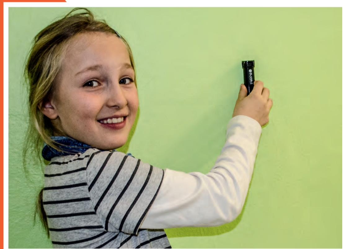
So klein ist ein Datenlogger, der eine ganze Woche lang alle 5 Minuten die Temperatur misst und die Daten speichert, so dass man sie am Computer auswerten kann.
