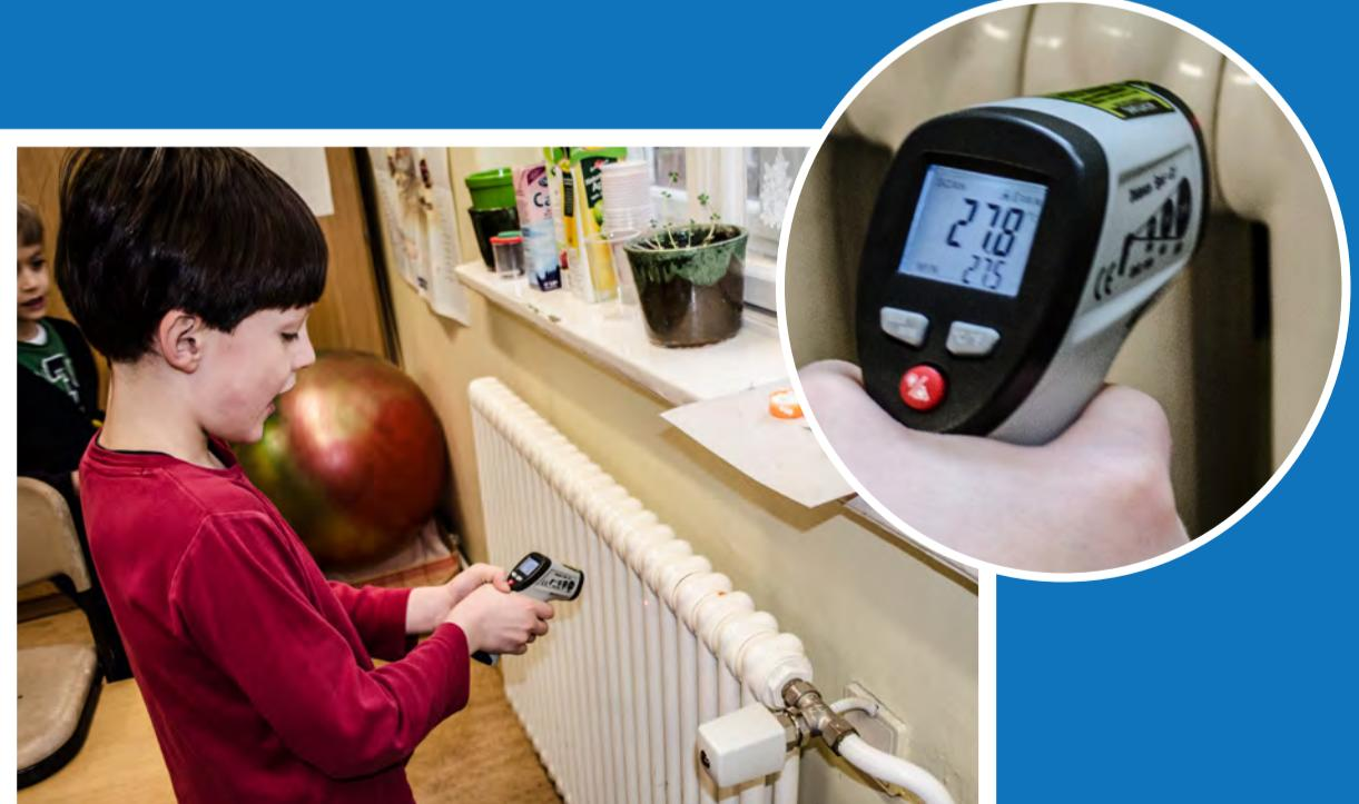
Hier sieht man Konrad, wie er mit einem Infrarotthermometer die Oberflächentemperatur eines Heizkörpers misst.
