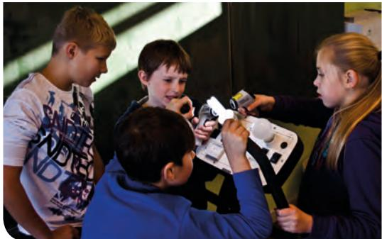
Dass bei einer Energiesparlampe sehr viel weniger Strom in Wärme umgewandelt wird wie bei einer Glühbirne, erarbeiten sich die Schüler mit dem Energierad und einem Infrarot-Messgerät experimentell.
