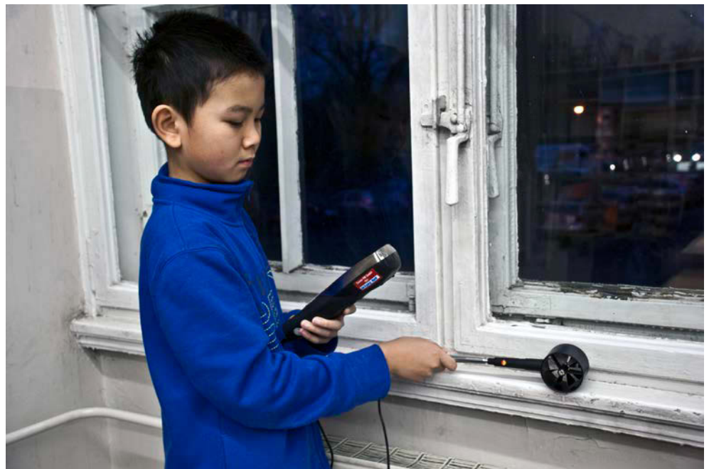
Messung der Luftströme an den Fensterfugen
