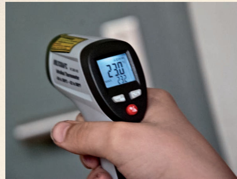
Wir haben mit einem digitalem Infrarotthermometer die Oberflächentemperaturen und mit einem Thermoelement-Messgerät die Lufttemperatur in den Klassen gemessen.
